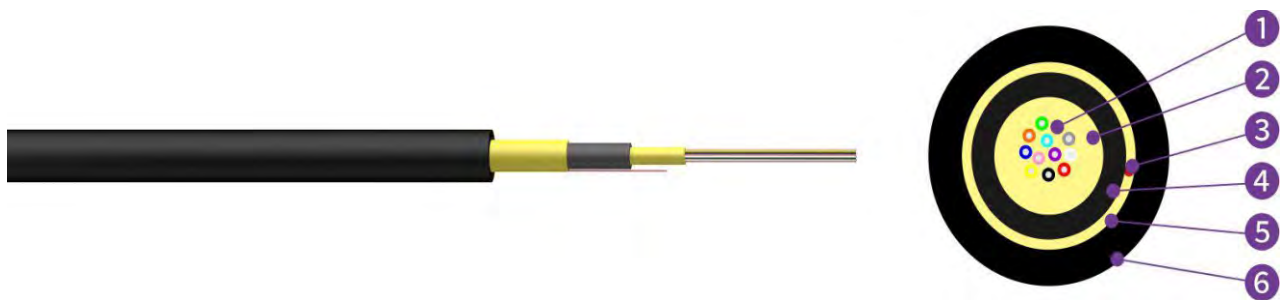
1,Fiber 2,Aramid Yarn 3,Ripcord 4,InnerSheath 5,Aramid Yarn 6,Outer Sheath
